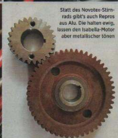
Das Antriebsrad der Nockenwelle ist irgendwann bei jedem Isabella-Motor fällig, lautes Getackker weist darauf hin
