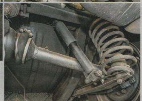
Führungsschwäche: Die Befestigung der Schubstreben an der Karosserie kann im Extremfall wegstören, ebenso wie die Streben selbst
